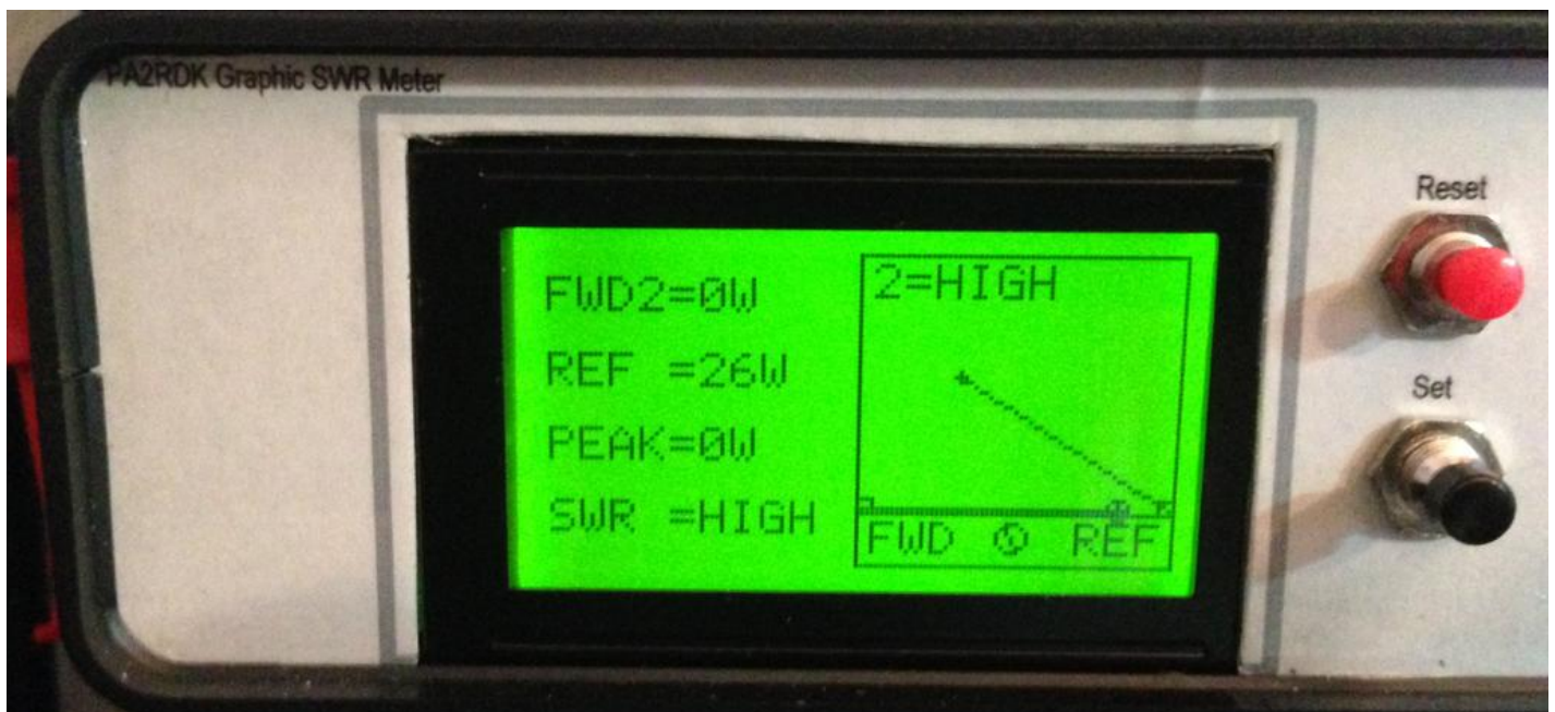
Meter "verkeerd om" aangesloten; wel reverse, geen forward. Dit om de lineairiteit te testen.
